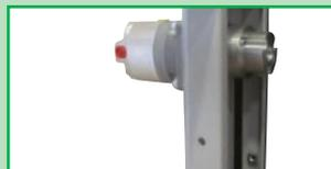
Entraînement par moteur hydraulique groupe 2 avec contre-palier et poulies.
